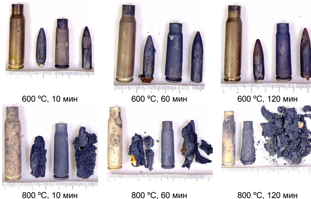
Рис. 5. Внешний вид пуль и гильз после обжига
