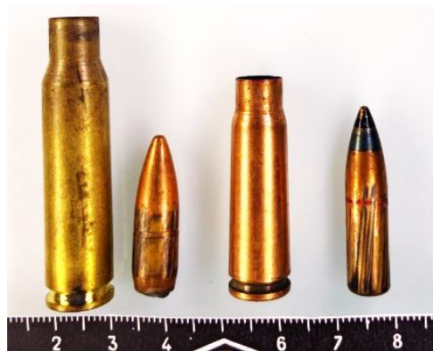
Рис. 1. Внешний вид выстреленных пуль и стреляных гильз, являвшихся частями патрона 7,62×51 мм (слева) и патрона 7,62×39 мм (справа)
